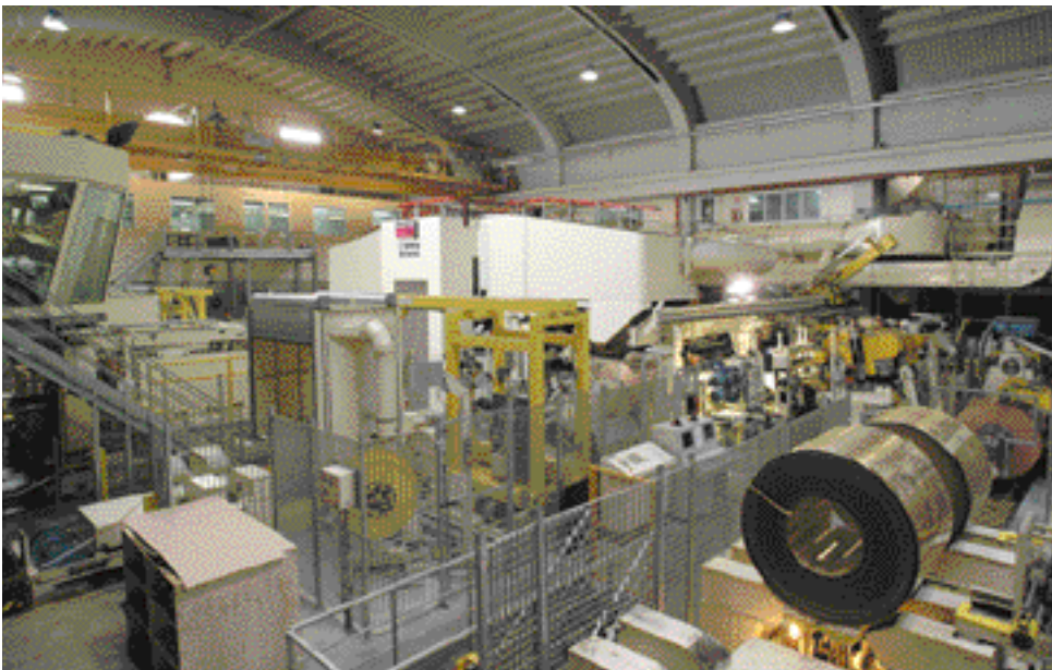
L'impianto di laminazione a freddo Sesto in grado di laminare 1000 m/minuto.
